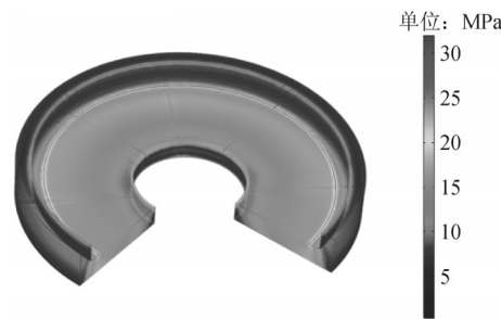
图 15 增加金属盘后环氧板材应力分布
